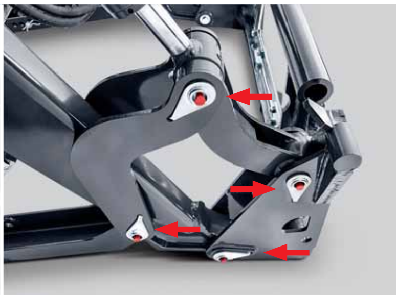
Безкомпромиссно для длительного срока службы: Все подшипники скольжения оснащены втулками из композитного материала и удобно смазываются снаружи.
