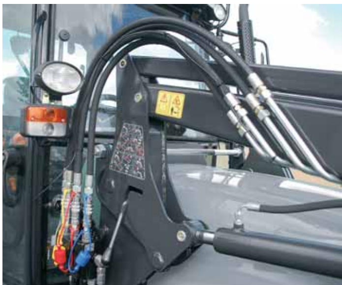
Быстрый монтаж/демонтаж погрузчика.
