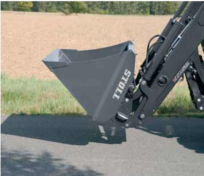
Отличные углы зачерпывания: ECO 650/750: 43°. ECO 850/950: 46°.
