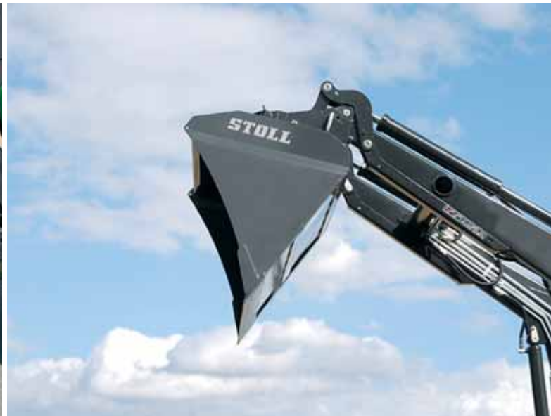
Очень хорошие углы опрокидывания: ECO 650/750: 63°. ECO 850/950: 58°.
